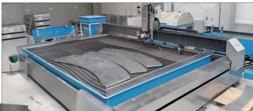
Pracoviště řezání materiálů vodním paprskem s CNC řízením. Vyrábí i polotovary ve tvaru půlměsíce, které jsou zapotřebí pro zhotovení některých dílů rakety
